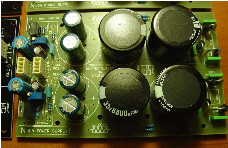
Na zdjęciu zasilacza widać brak gniazd ARK, dławików i diod przy stabilizatorach
